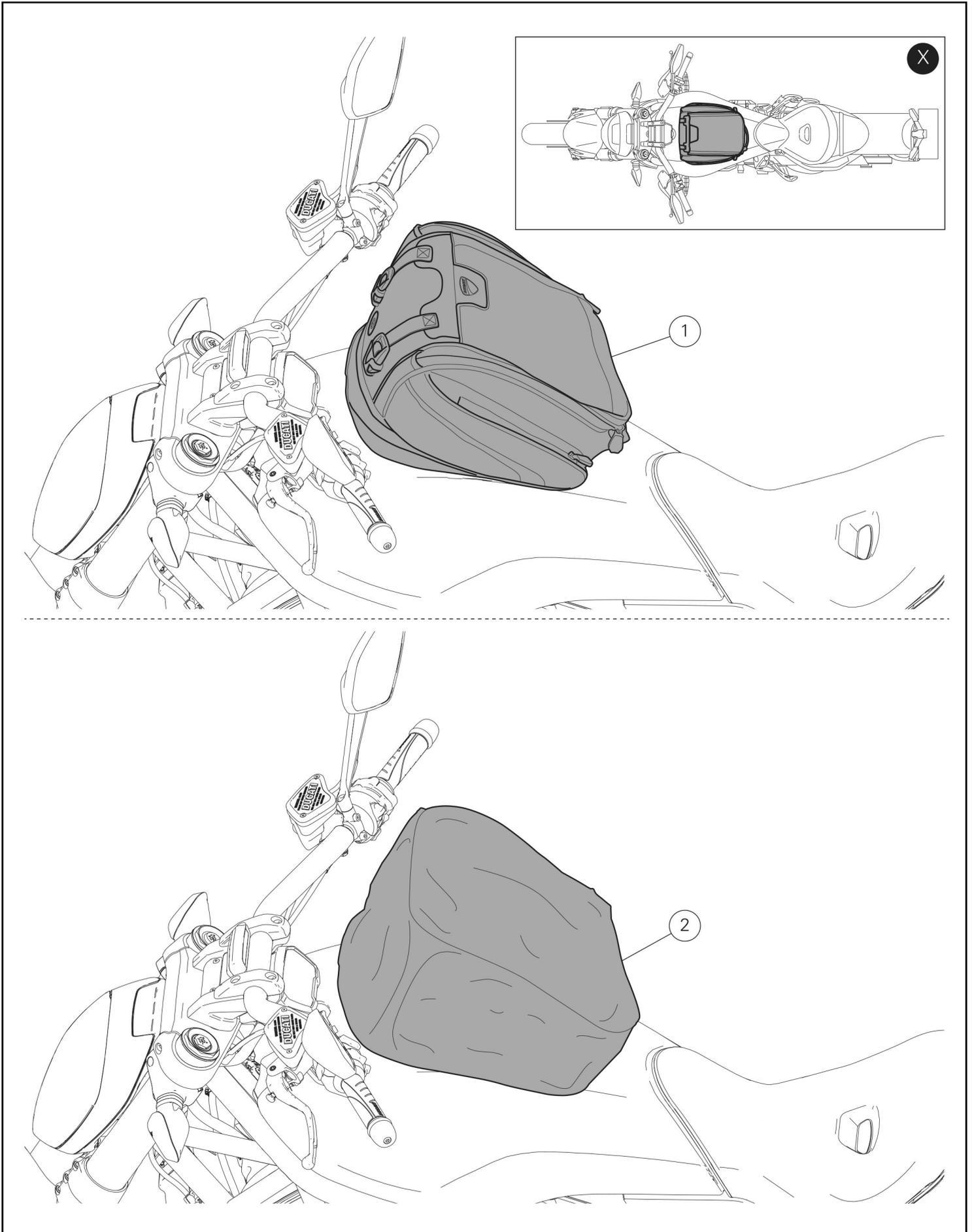
Posizionare la borsa (1) sul motoveicolo, centrandola sul serbatoio, come indicato in figura (X).
